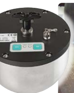
Obr. 2: Příklady měření rizik na veřejných zařízeních (rizika zachycení hlavy, stlačení hlavy pod úvratí houpačky, zkušební elektronická hlava pro posouzení dopadové plochy, zachycení prstu v blízkosti skazu)
