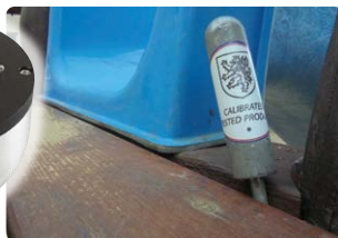
Obr. 2: Příklady měření rizik na veřejných zařízeních (rizika zachycení hlavy, stlačení hlavy pod úvratí houpačky, zkušební elektronická hlava pro posouzení dopadové plochy, zachycení prstu v blízkosti skazu)
