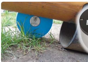
Obr. 2: Příklady měření rizik na veřejných zařízeních (rizika zachycení hlavy, stlačení hlavy pod úvratí houpačky, zkušební elektronická hlava pro posouzení dopadové plochy, zachycení prstu v blízkosti skazu)
