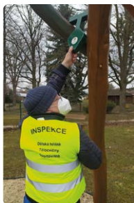
Obr. 2: Příklady měření rizik na veřejných zařízeních (rizika zachycení hlavy, stlačení hlavy pod úvratí houpačky, zkušební elektronická hlava pro posouzení dopadové plochy, zachycení prstu v blízkosti skazu)
